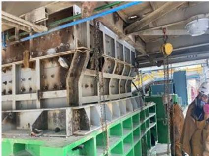
Simulación de operación en abastecimiento de material en Chancado, la plancha lateral de chute se encontraba con todos sus pernos.
