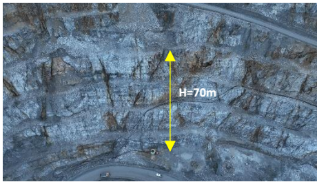
Fig.01.- Altura desde donde se desprende el bloque de roca
