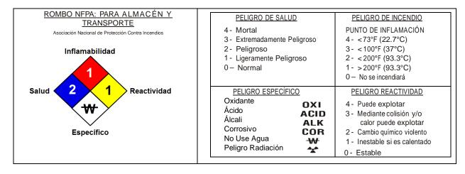
NOTA. El rombo de la NFPA para el almacenamiento variará de tamaño según donde se lo coloque. Este se debe utilizar en:
