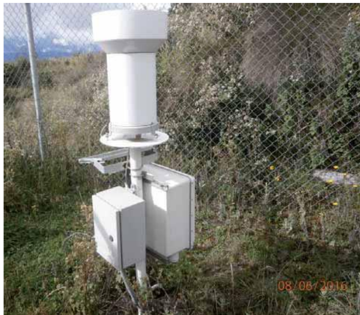
Fotografía 4.1: Estación pluviométrica Cerro Candela.
